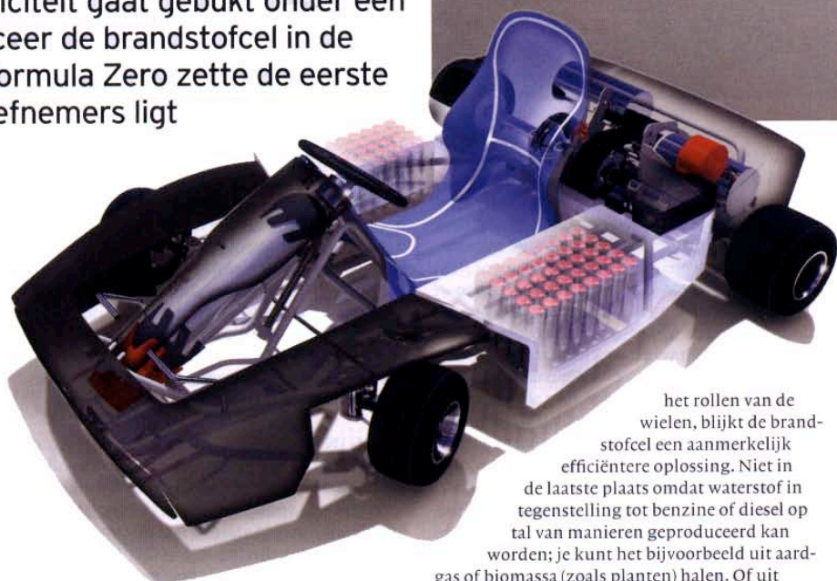
Opgewekte elektriciteit wordt opgeslagen in tientallen boostcaps aan weerszijden van het stoeltje. De waterstof zit in een tankje op de neus (linksboven).
